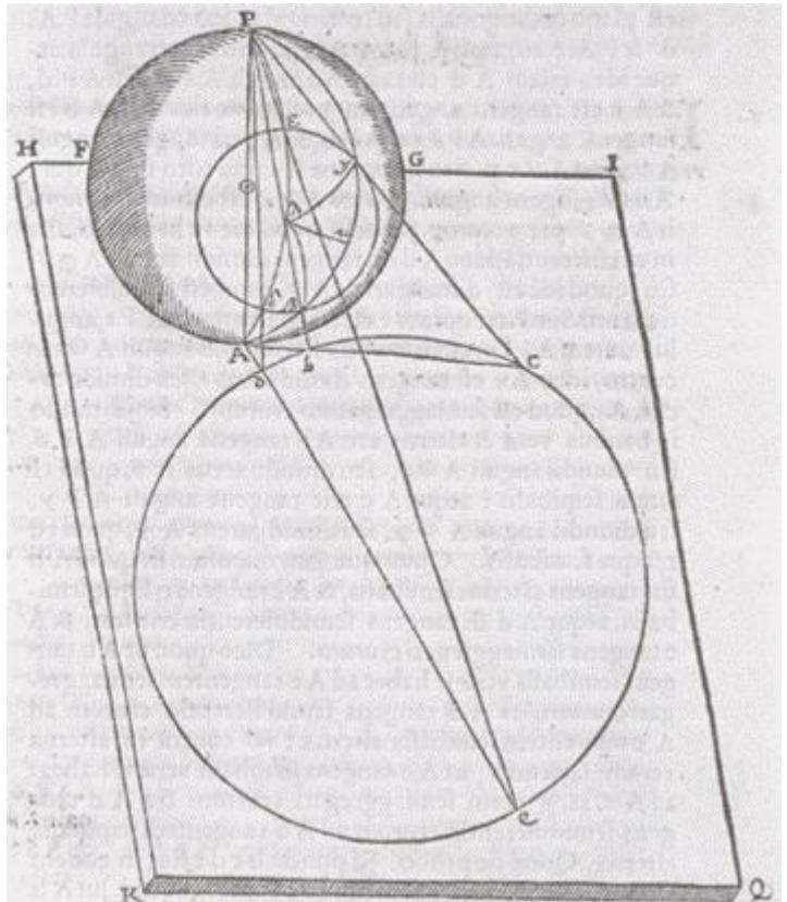
る。これは光学の理論や、天文観測器の製作からも明らかな事実である。さて、この  $\varepsilon \beta \gamma$  の円は、球の表面に描かれている。そして光源 P は、その円周の外にある。その光源から球の中心を通って引いた直線 POA は、投影を受ける平面に垂直である。したがって必然的に、d,b,c,e の点を通る影は円形である。したがって、Ab と Ae の関係は Ad と Ac の関係と同じであり、その逆も成り立つ。すなわち、「真の半基線の正接：脚の半和の正接=脚の半差の正接：交代の半基線の正接」が成り立つ。したがって、真の半基線に対応する差は、脚の半和と半差に対応する差の和から引き算したものに等しくなる。それが交代の半基線に対応する差に等しい。これこそ、われわれが証明しようとしたことである。
